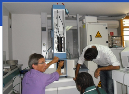
Nouvel analyseur de poussières en temps réel : TEOM 1405-F
