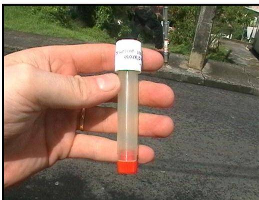
La méthode de prélèvement du NO<sub>2</sub> est celle des tubes passifs. Le principe général consiste en un tube vertical ouvert à sa partie inférieure, et contenant en sa partie supérieure interne, un support solide (grilles) imprégné d'une substance chimique (triéthanolamine+BRIJ35) adaptée à l'absorption de NO<sub>2</sub> qui diffuse naturellement dans le tube.
