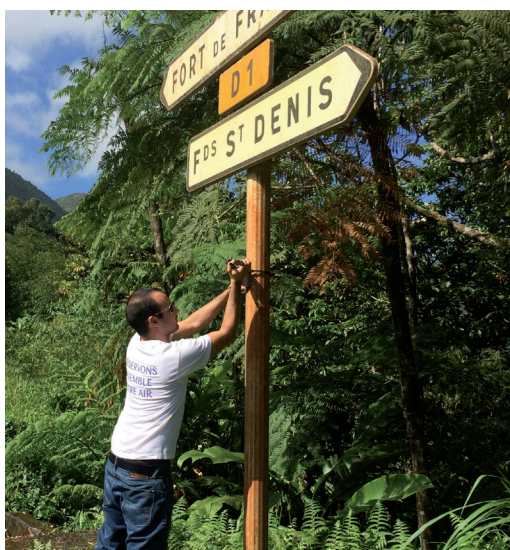
Figure 4. Mesures par prélèvements passifs du dioxyde d'azote à Fonds Saint-Denis
