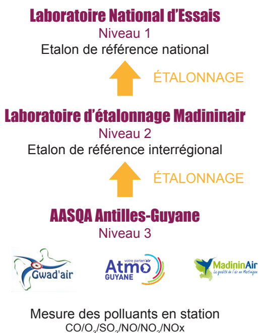
Figure 4. Le laboratoire d'étalonnage niveau 2 de Madinair au sein de la chaîne nationale
