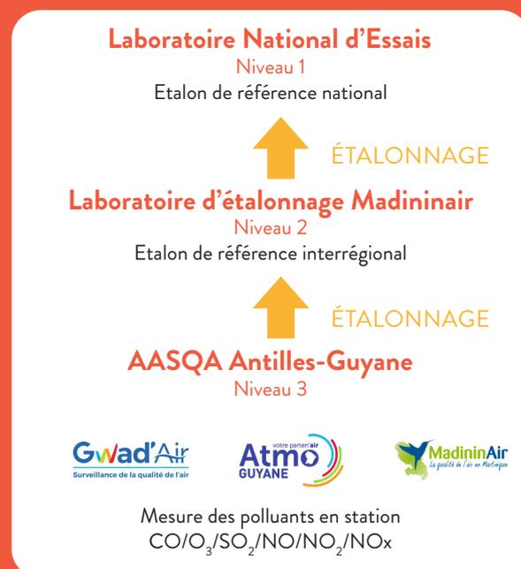
Figure 2. Le laboratoire d'étalonnage niveau 2 de Madininair au sein de la chaîne nationale
