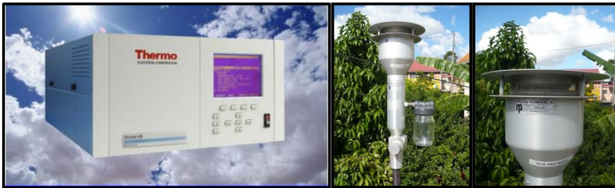
Figure 7: Dispositif permettant l'analyse automatique de l'H 2 S à la station fixe du Bourg au Robert. A gauche l'analyseur automatique et à droite la tête de prélèvement.
