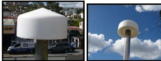
La méthode de prélèvement utilisée au niveau des stations et du camion laboratoire est la méthode par voie active. L'air est aspiré à l'aide d'une pompe à travers une tête de prélèvement puis analysé en continu par l'appareil de mesure d'un polluant spécifique.
