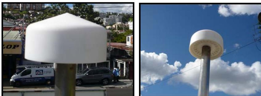
Le dispositif de prélèvement est formé d'une canne de prélèvement et d'un tube reliant celle-ci à l'analyseur. La tête de prélèvement située à l'extrémité de la canne est en forme de cône criblé à sa base. Seul l'air pompé passe à travers les cribles, les grosses particules sont stoppées par le diamètre trop étroit des trous, permettant ainsi d'éviter l'occlusion du tube de prélèvement.
