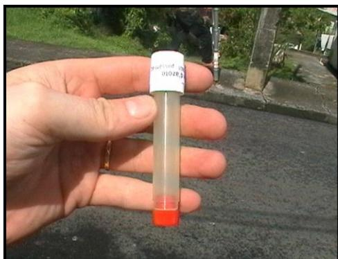
Le prélèvement du  $\text{NO}_2$  se fait par une méthode dite « tubes passifs ». Le principe général de celle-ci consiste à laisser diffuser le  $\text{NO}_2$  dans un tube vertical ouvert en inférieure, afin que la particule d'intérêt (le  $\text{NO}_2$ ) soit adsorbée par une substance chimique (triéthanolamine+BRIJ35) présente sur un support solide (une grille) sur la partie interne supérieure du tube.
