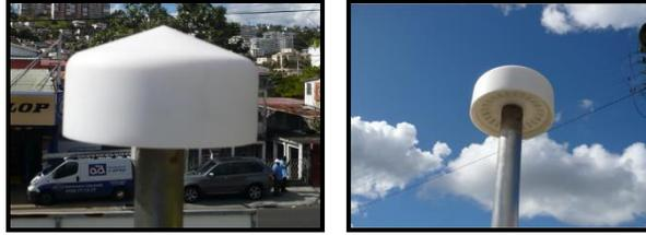
La méthode de prélèvement utilisée par les stations fixes et les dispositifs mobiles est la méthode par voie active. L'air est aspiré à l'aide d'une pompe à travers une tête de prélèvement puis analysé en continu par l'appareil de mesure d'un polluant spécifique.
