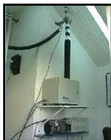
L'analyseur PM10 mesure à température ambiante, la masse de particules inférieures à 10 microns.
