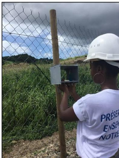
Les tubes sont posés à environ 2 mètres du sol, essentiellement pour des raisons de vandalisme, sur des supports (lampadaire, poteau...) tout en restant représentatifs de l'air respirable. Les tubes sont posés sur des supports qui sont fixés au poteau à l'aide de collier de serrage.
