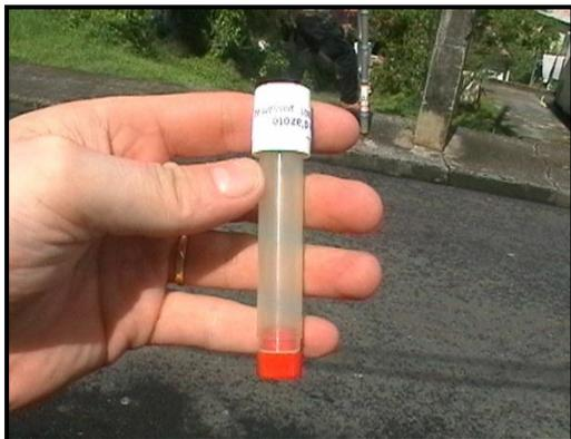
La méthode de prélèvement du dioxyde d'azote est celle des tubes passifs. Le principe général consiste en un tube vertical ouvert à sa partie inférieure, et contenant en sa partie supérieure interne, un support solide (grilles) imprégné d'une substance chimique (triéthanolamine+BRIJ35) adaptée à l'absorption de  $\text{NO}_2$  qui diffuse naturellement dans le tube.
