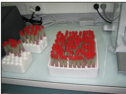
Après échantillonnage, les tubes sont analysés le plus rapidement possible par le laboratoire de Madinair. L'analyse se fait par spectrophotométrie. Dans chaque tube l'ajout d'une solution, qui réagit avec le  $\text{NO}_2^-$ , donne une coloration plus ou moins rose en fonction de la concentration en  $\text{NO}_2^-$ .
