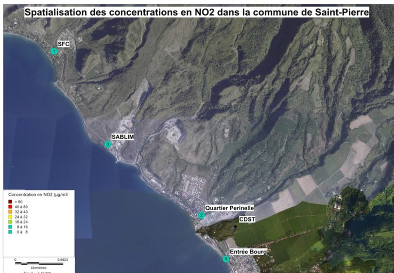
Les concentrations en dioxyde d'azote sont relativement faibles sur l'ensemble des sites de mesure. Avec un maximum de  $9 \mu\text{g}/\text{m}^3$  atteint sur le site « Entrée Nord Bourg », ce site est de par son implantation le plus exposé au trafic automobile. Toutefois, la concentration moyenne enregistrée sur la période de mesure pour l'année 2016/2017 représente un risque faible de dépassement des normes environnementales.
