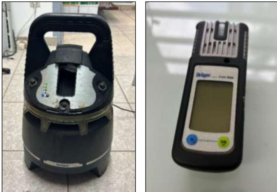
Figure 3 : Photographies d'un dispositif Dräger constitué d'une batterie portable et d'un capteur
