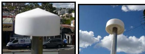
La méthode de prélèvement utilisée au niveau des stations et du camion laboratoire est la méthode par voie active. L'air est aspiré à l'aide d'une pompe à travers une tête de prélèvement puis analysé en continu par l'appareil de mesure d'un polluant spécifique.
